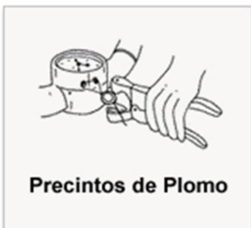
La Segunda generación de precintos de seguridad era fabricada con metales maleables, tales como el plomo y el estaño, los cuales eran después marcados y sellados con unos alicates.
