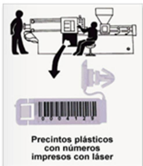
En esta Generación Se desarrolló el más nuevo sistema de numeración llamado "in mold label". Números, **código de barras** y logomarca del cliente son impresos con láser en papel fundido a la lámina del precinto **durante** el proceso de fabricación. Dígito verificador y código de barras reducen errores de transcripción a zero, maximizando la seguridad.
